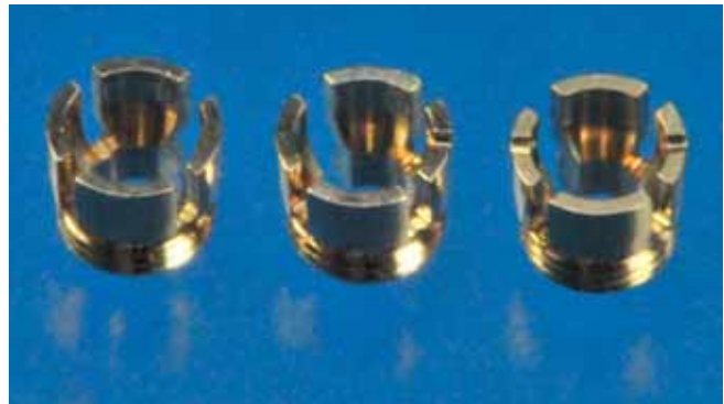
Fig. 7 Différents inserts de rétention à lamelles pour la partie femelle Dalbo®-Plus: (de gauche à droite) Standard (diamètre intérieur 2,28 mm, pas de cannelure); Tuning soft (diamètre intérieur 2,25 mm, une cannelure); Tuning (diamètre intérieur 2,22 mm, deux cannelures)
