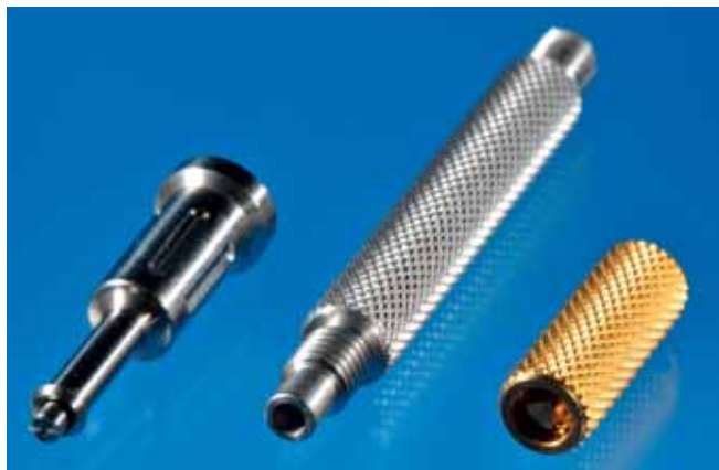
Fig. 11 L'outil Locator® Core Tool se compose de trois parties: la pointe pour le retrait des inserts, la tige manchon servant à insérer et à impacter le nouvel insert, ainsi qu'un tournevis universel (couleur dorée) pour l'insertion et le vissage de l'attachement (femelle) Locator®.
